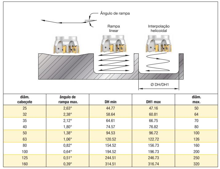
DH min = Diâmetro mínimo de furo com interpolação helicoidal
