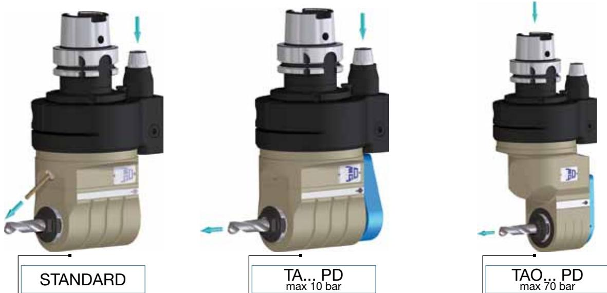
**Il circuito refrigerante è standard** - Tutte le teste sono provviste di canalizzazione interna, che parte dal perno dell'antirottante e termina sull'ugello vicino all'utensile, senza alcun costo aggiuntivo.
