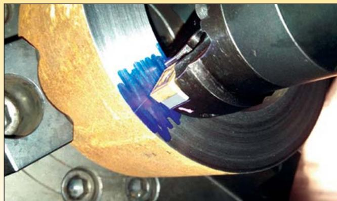
**Figura 5:** Altura central da barra de mandrilar**Faça o pedido do kit de ferramentas da Kennametal de alinhamento para altura central**
