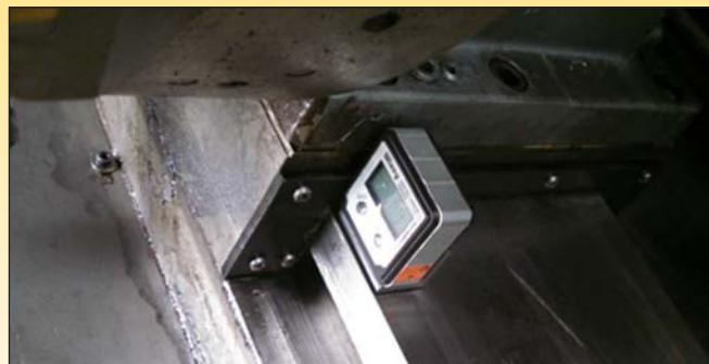
**Figura 2:** Calibração do eixo X
