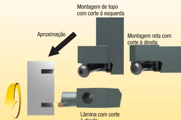
Curvatura para fora com corte à direita
